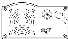
Akku wird geladen: gelbes und rotes LED leuchtet
